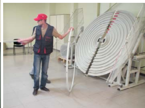
Ring av rør trekkes til brudd
